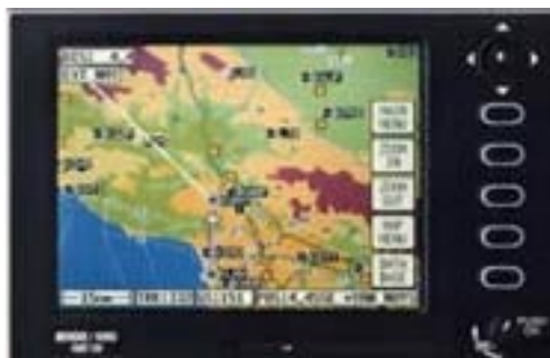
Bildet viser en King 150 som er et GPS-kartsystem som er fast montert i både LN-DFL og LN-DFK.
